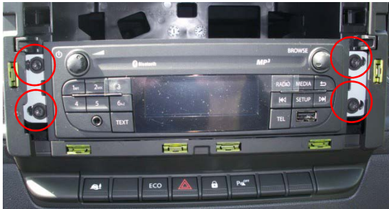
Retirer les vis de fixation de l'autoradio d'origine
