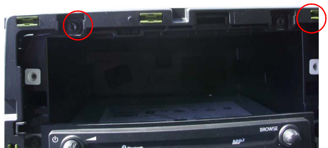
Retirer les deux vis en haut et incliné le cadre de façon à pouvoir retirer l'autoradio
