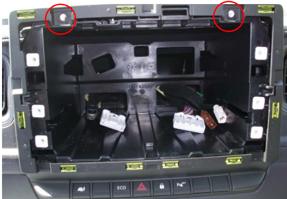
Après avoir retiré l'autoradio, resserrer les vis du dessus
